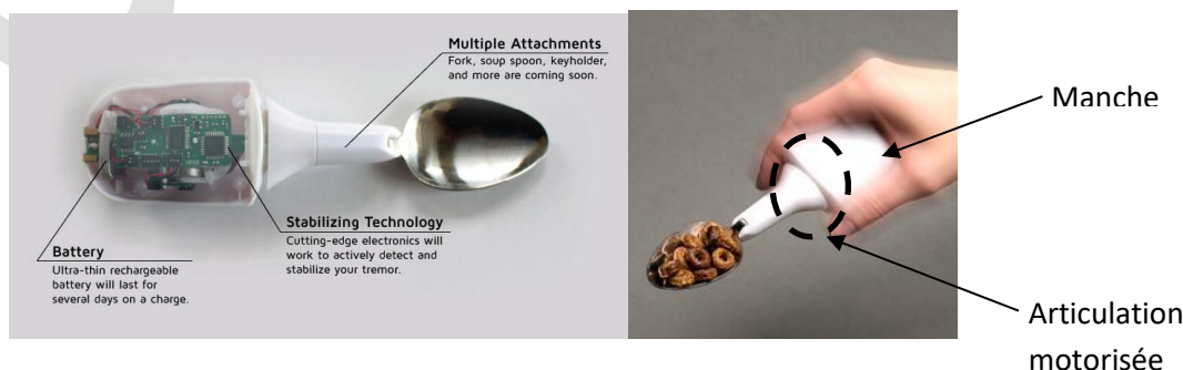
Figure 2 : Descriptif de la cuillère stabilisatrice
